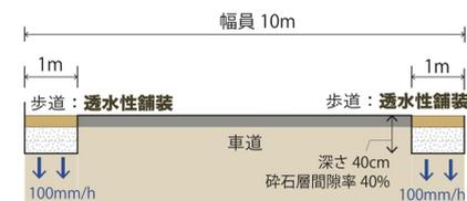
図-7 2車線道路への導入モデルイメージ(断面)
