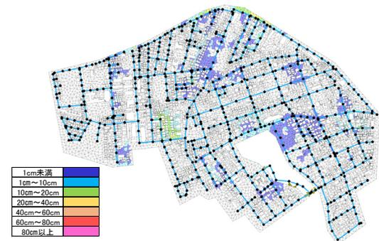
図-15 GI 全対策導入時の氾濫解析の結果 (極端豪雨)
